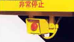
非常停止ボタン
